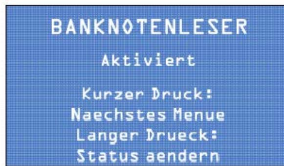
Durch kurzen Druck auf die Wahltaste auf das nächste Menü zugreifen. Durch anhaltenden Druck auf die Wahltaste den Banknotenprüfer ein- bzw. ausschalten.
