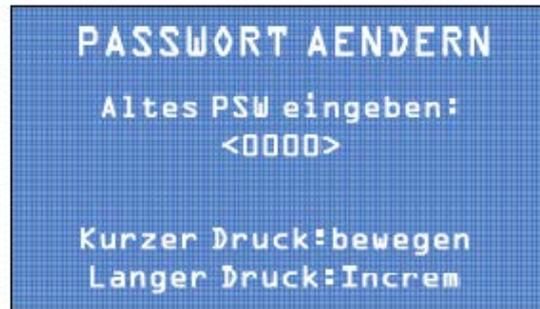
Durch kurzen Tastendruck den Cursor von einer Zahl zur nächsten bewegen. Durch anhaltenden Tastendruck den Wert der ausgewählten Zahl erhöhen. Anschließend die Taste anhaltend drücken, um die Eingabe zu bestätigen und auf die nächste Seite zu wechseln.
