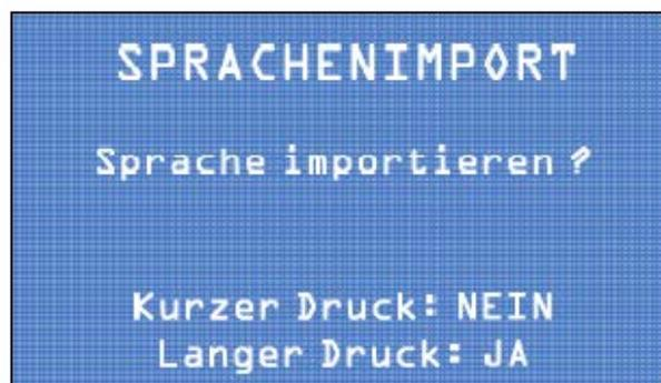
Durch kurzen Druck auf die Wahl taste auf das nächste Menü zugreifen. Durch anhaltenden Druck das Sprachpaket von der SD-Karte in die CPU-Platine importieren.
