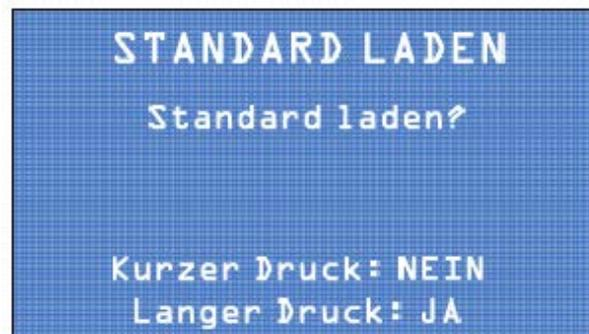
Bei kurzem Drücken der Wahltaste wird das Gerät nicht auf die Standardeinstellungen zurückgesetzt und das nächste Menü wird angezeigt. Bei anhaltendem Druck wird das Gerät auf die Standardeinstellungen zurückgesetzt. Anschließend erscheint die nächste Bildschirmseite.
