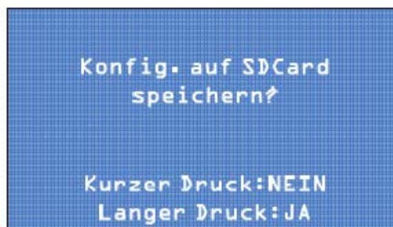
Bei kurzem Tastendruck wird die Funktion verlassen, ohne die Konfiguration zu speichern. Bei langem Tastendruck wird die Konfiguration auf der integrierten SD-Karte gespeichert.
