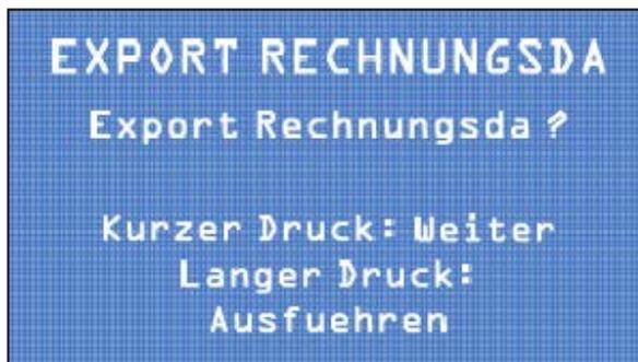
Durch kurzen Tastendruck die Funktion verlassen, durch langen Tastendruck den Export der Buchhaltungsdaten bestätigen.
