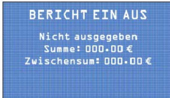
Durch kurzes Drücken der Wahltaste wird die nachfolgende Seite mit den Buchhaltungsdaten für die eingeführten Banknoten angezeigt.
