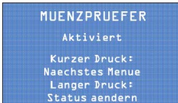
Durch kurzen Druck auf die Wahltaste auf das nächste Menü zugreifen. Durch anhaltenden Druck der Wahltaste den Münzprüfer ein- bzw. ausschalten.
