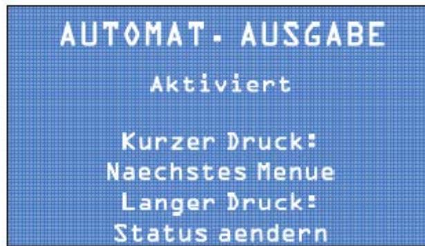
Durch kurzen Druck auf die Wahltaste auf das nächste Menü zugreifen. Durch anhaltenden Druck die automatische Ausgabe ein- bzw. ausschalten.
