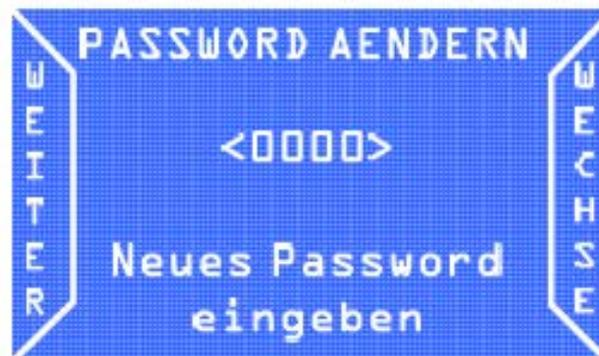
Den Cursor mit der Option WEITER von einer Zahl auf die nächste versetzen. Anschließend die Taste anhaltend drücken, um die Passworteingabe zu bestätigen und auf die nächste Seite zu wechseln.
