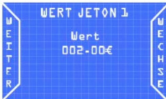
Mit der linken Taste (WEITER) und der rechten Taste (WECHSE) wird den Jetons ein Wert in Euro zugewiesen.
