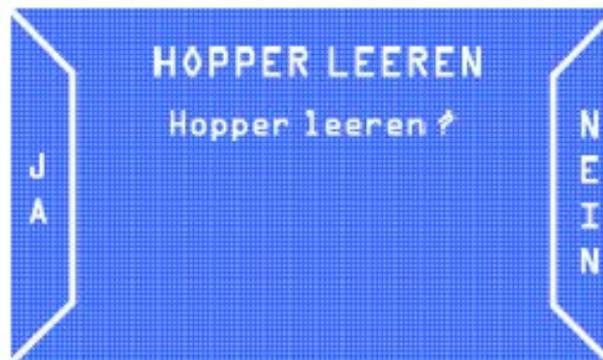
Mit der Option JA wird die automatische Entleerung des Hoppers aktiviert. Mit der Option NEIN wird die nachfolgende Bildschirmseite aufgerufen.
