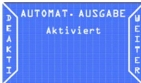
Durch Auswahl der Option WEITER auf das nächste Menü zugreifen. Mit der Funktion AKTIV/DEAKTI die automatische Ausgabe aktivieren bzw. deaktivieren.
