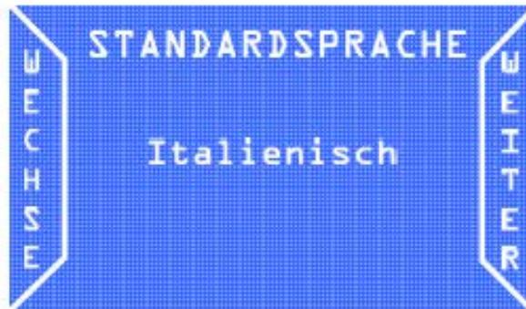
Durch Auswahl der Option WEITER auf das nächste Menü zugreifen. Mit der Option WECHSE die Spracheinstellung ändern.
