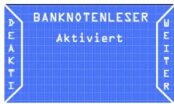
Durch Auswahl der Option WEITER auf das nächste Menü zugreifen. Mit der Funktion AKTIV/DEAKTI den Banknotenprüfer aktivieren bzw. deaktivieren.
