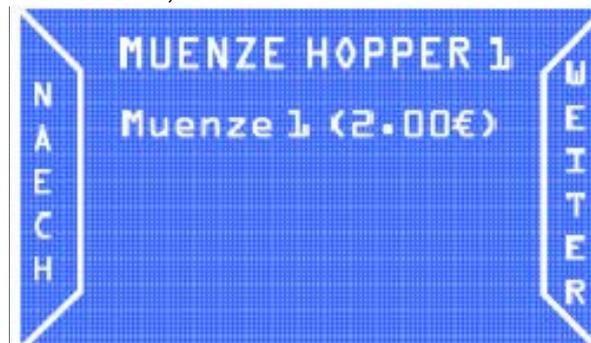
Mit der Option WEITER auf das nächste Menü zugreifen. Mit der Taste NAECH zum nächsten Münztyp wechseln.
