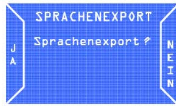
Durch Auswahl der Option NEIN auf das nächste Menü zugreifen. Mit der Option JA den Export des Sprachpakets in die SD-Karte aktivieren.
