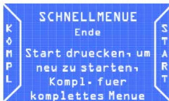
Bei Auswahl der Funktion START kehrt das Programm an den Anfang des Schnellmenüs zurück. Mit der Funktion KOMPL kann auf das Gesamtmenü zugegriffen werden.
