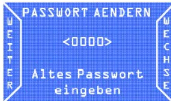
Den Cursor mit der Option WEITER von einer Zahl auf die nächste versetzen. Mit der Option WECHSE den Wert der ausgewählten Zahl erhöhen. Anschließend muss das neue Passwort erneut eingegeben werden:
